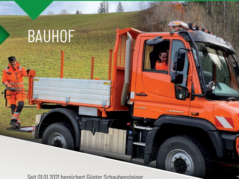
Seit September 2021 ist der neue UNIMOG U430 am Bauhof im Einsatz. Das Fahrzeug verfügt über einen leistungsstarken Motor mit 300 PS. Die zuschaltbare Allradlenkung sowie die Wechsellenkung erhöhen in vielen Arbeitsbereichen den Komfort und die Sicherheit. Die Anbaugeräte wie Schneepflug, Streugerät, Mähgerät konnten allesamt vom ICB Fastrac übernommen bzw. adaptiert werden. Der ICB Fastrac welcher seit 2006 in Forstau im Einsatz war, wurde von der Firma Pappas eingetauscht.
